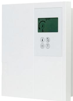
Elektr. Steuerung für finnische Sauna mit LCD-Anzeige. Stufenlose Regelung zw. 70 und 115 °C, Heizzeitbegrenzung 6 h, Schaltleistung 9 kW. Anzeige der Temperatur und Restlaufzeit. Temperaturfühler mit Kabel (3 m) inkludiert, Sicherheitstemperaturbegrenzung bei 141 °C, Licht Ein/Aus.
