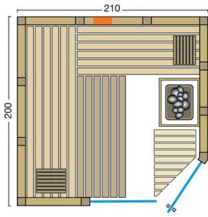
**Abbildung Classico Tanne mit Sonderausstattung:** Eckeinstieg mit Tür ohne Schwelle, großes Glaselement, Inneneinrichtung Linea, VITALlight-IPX4-Strahler mit Rückenpolster, LED-Beleuchtung, Verdampferofen Hotline S8, Steuerung Saunacontrol T4.
