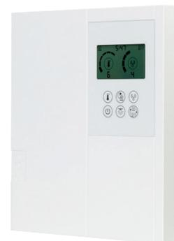
Elektr. Steuerung für Sauna- und Feuchtebetrieb. Stufenlose Regelung zw. 33 und 65 °C im Feuchtebetrieb bzw. 70 – 115 °C im Saunabetrieb. Heizzeitbegrenzung 6 h, Schaltleistung 9 kW, Verdampfer 3 kW. 9-Stufen-Feuchtetaktung mit Wassermangelerkennung und Nachheizfunktion. Anzeige der Temperatur und Restlaufzeit. Temperaturfühler mit 3 m Kabel, Sicherheitstemperaturbegrenzung bei 141 °C, Licht Ein/Aus.
