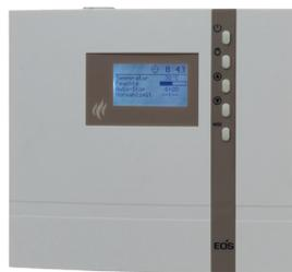
Elektr. Steuerung für Sauna- und Feuchtebetrieb. Stufenlose Regelung zw. 30 und 70 °C im Feuchtebetrieb bzw. 40 – 115 °C im Saunabetrieb. Heizzeitbegrenzung 6 h (12 h), Schaltleistung 9 kW (erweiterbar mit LSG), Verdampfer 3 kW. 5-Stufen-Feuchtetaktung mit Wassermangelerkennung und Nachheizfunktion. Digitale Anzeige der Uhrzeit, Temperatur, Feuchte und Restlaufzeit.
